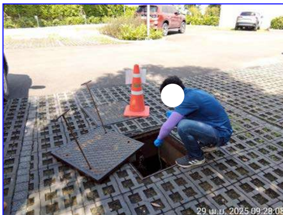
รูปที่ 3.2 แสดงการเก็บตัวอย่างน้ำผ่านการบำบัด (Effluent)
